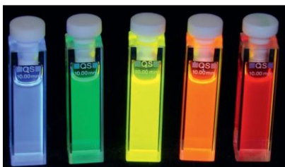
Figura 2: Canvi del color d'emissió d'una solució col·loïdal de QDs de CdSe depenent de la mida [Ref. 1].
