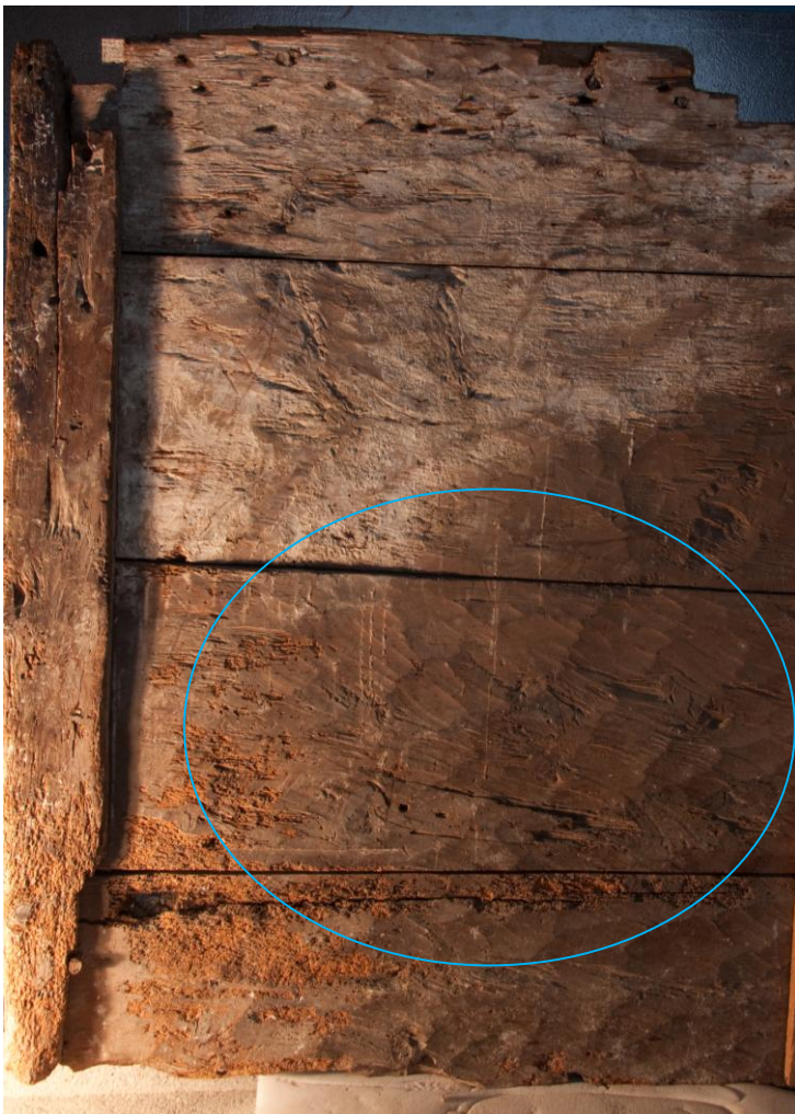
▲ Fig. 11. Senyals de l'aixa corba en la cara posterior del frontal. Cada senyal fa uns 5x2 cm, aproximadament.
