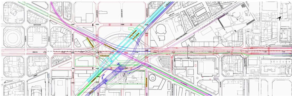
**Fig. 58** En estas imágenes se aprecia en resumen la propuesta de ocupación espacial del ámbito de la plaza que contiene la MPGM, la imagen inferior engloba el trazado de los sistemas de ferrocarriles, las estaciones y los cruces vehiculares que se encontrarán en el subsuelo de la plaza. Fuente: Modificació del PGM a la Plaça de les Glòries i el seu Entorn. Anexo. Ayuntamiento de Barcelona.
