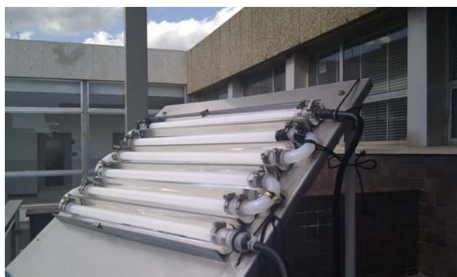
Fig. 1.39- Planta piloto para fotocatalisis solar con CPCs, Universidad de Barcelona
