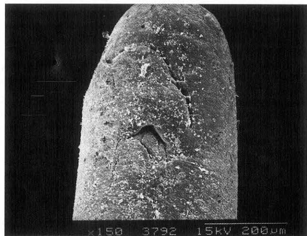
Fig. 1. Se observa un elevado número de partículas diseminadas en la porción apical de la punta de gutapercha (X150).
