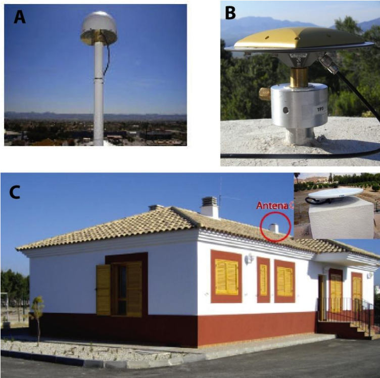
Fig. 2: Estaciones GPS en las inmediaciones de Lorca. A) Estación permanente LORC de la red REGAM ( www.cartomur.com/geodesia/lorca.htm ). B) Estación TERC de la red CuaTeNeo situada en la Sierra de Tercia. C) Estación continua LRCA de la red Meristemum (imágenes cedidas por la Dirección General de Medio Ambiente de la Región de Murcia).
