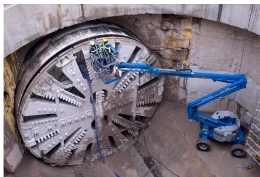
Figura 2.12. Detall del capçal de perforació d'una màquina tuneladora.
