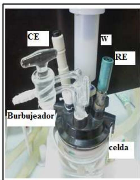
**Fig.3.1. Disposición de los electrodos en la celda termostatzada: electrodo de trabajo (W) depositado sobre un RDE, referencia (RE) y contraelectrodo (CE).**
