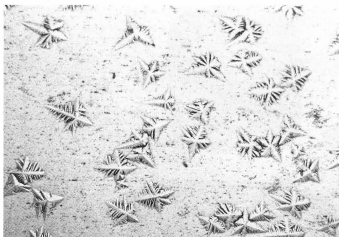
Figura 3. Microestructura formada por austenita (fase matriz) y martensita (forma estrellada).
