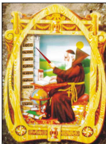
Fig. 3-10. Higròmetre mecànic de cabell (higròmetre del frare)
