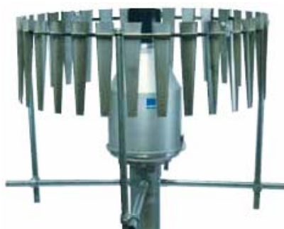
Fig 4-2. Paravents en un pluviòmetre de pesada
