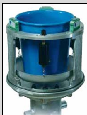
Fig. 4-6. Galleda col·lectora i sensor Geonor T-200B (Font: Geonor)
