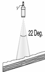
Fig. 8-1. Perpendicularitat del feix d'ultrasons (Font: Manual SR50 Campbell Scientific )
