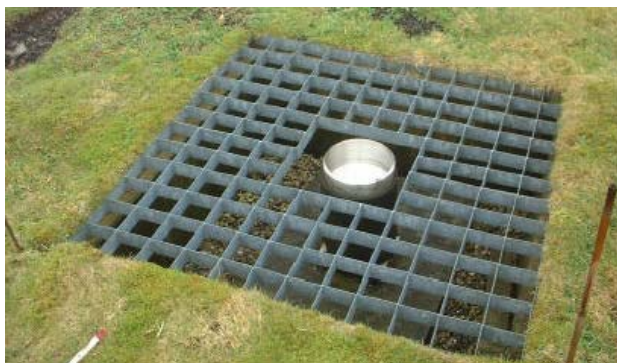
Fig 4-3. Fotografia d'un pluviòmetre de balanci amb la boca situada a nivell de terra
