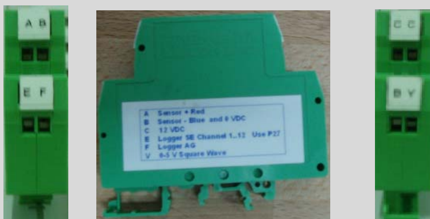
Fig. 4-11. Fotografia adaptador senyal 455055 Geonor T-200B (Font: SMC)
