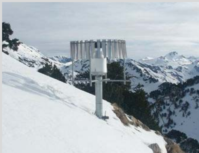
Fig. 4-4. Fotografia pluviòmetre Geonor T-200B ja instal·lat (Font: Servei Meteorològic de Catalunya (SMC))
