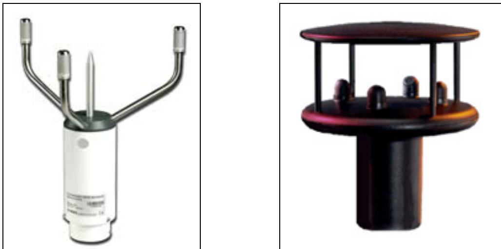
Fig. 5-9. Fotografia de dos sensors de vent d'ultrasons (Font: Vaisala (esquerra) i Gill Instruments (dreta))
