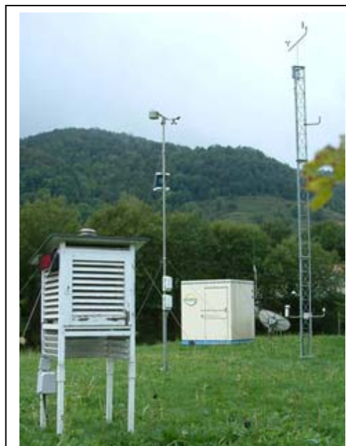
Estación meteorológica. Se aprecian dos anemómetros a distintas alturas, la torre que aloja el termómetro y al fondo una estación automática. (Sant Pau de Segúries, España)
