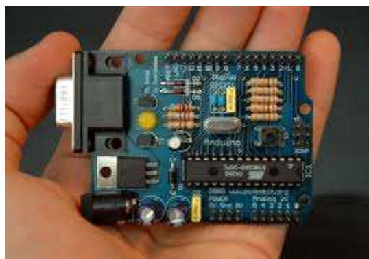
Ilustración 4: Versión original de la primera placa de Arduino
