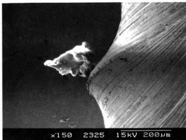
Fig. 5 Espolón de unos 100 micrómetros situado perpendicularmente a la superficie de la lima (x 150)
