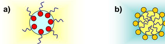
Figura I.2. Esquema de la disposición de las moléculas de tensioactivo a) con un HLB bajo en una emulsión W/O y b) con un HLB alto en una emulsión O/W.
