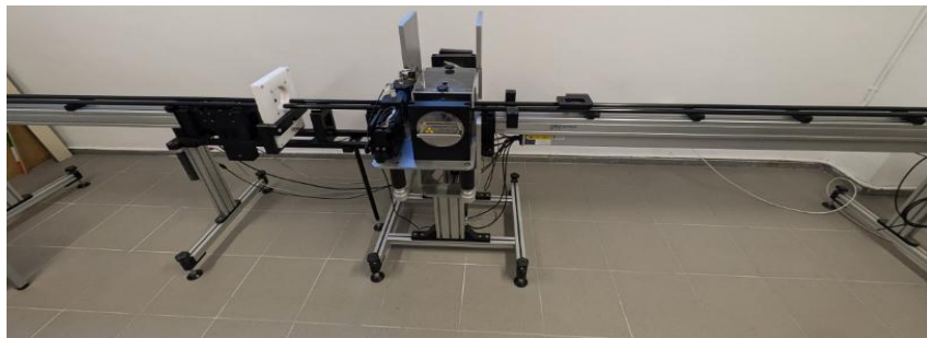
Figura 4. Imagen del soporte del testigo y la caja en la que se encuentra el láser emisor que registra cada centímetro de los testigos estudiados.
